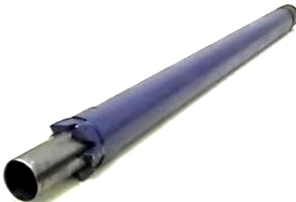
Слика 2.12: Цилиндар са клипом за узимање узорака, Pitcher
