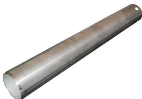
Слика 2.7: Димензије типичног цилиндра за узорке типа Shelby и параметри танкозидних цилиндара у функцији од унутрашњег пречника
